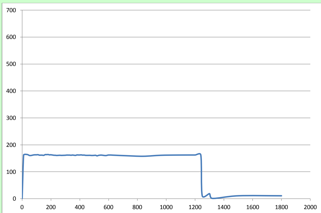
Consommation du chauffe-ballon pendant la durée de la manipulation (en tenant compte de la consommation d'énergie pour l'élimination du solvant) – Puissance en Watt en fonction du temps en seconde
